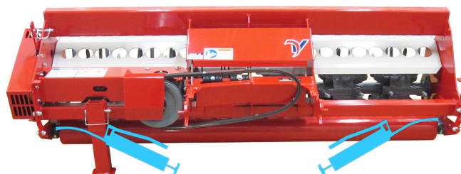
Volitelný secí stroj – naolejujte hnací řetěz.
