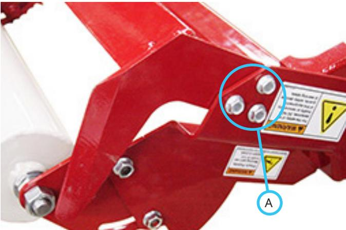
3. Entfernen Sie das alte Schneidmesser und setzen Sie das neue Schneidmesser ein.
