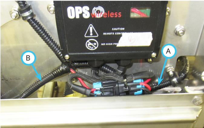
4. Trennen Sie den Motorkabelstrang (B) vom Steckverbinder des Steuergeräts, und schließen Sie den Steckverbinder des Motorkabelstrangs und den Steckverbinder des Stromversorgungskabelstrangs zusammen.
