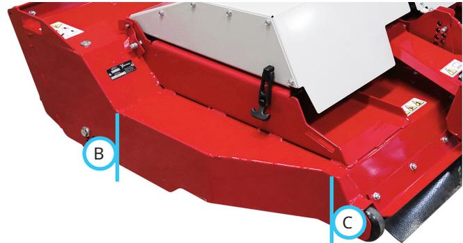
9. Stellen Sie die Stifte der Anhängervorrichtung in eine höhere Position, um das Heck des Mähwerks abzusenken. Um das Heck des Mähwerks anzuheben, verschieben Sie die Stifte der Anhängervorrichtung in eine niedrigere Position.
