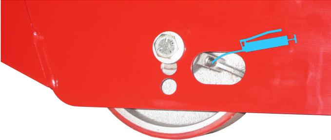
2. Fetten Sie die Achsen und Drehpunkte der Laufräder ein.
