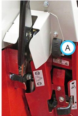
Wenn der Schalter eingeschaltet ist, werden die Ladearme über den primären SDLA-Steuerhebel gesteuert. Ziehen Sie den primären SDLA-Steuerhebel nach links, um den Ladearm anzuheben. Drücken Sie den primären SDLA-Steuerhebel nach rechts, um den Ladearm abzusenken.
