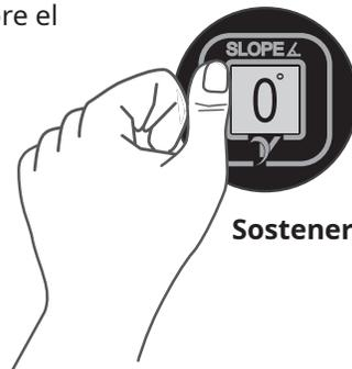
Empezando debajo de la zona del sensor, deslice el dedo pulgar hacia arriba por el sensor para desplazarse por las opciones como pueden ser puntos de ajuste de las alertas sonoras o visuales o las opciones de pantalla.
