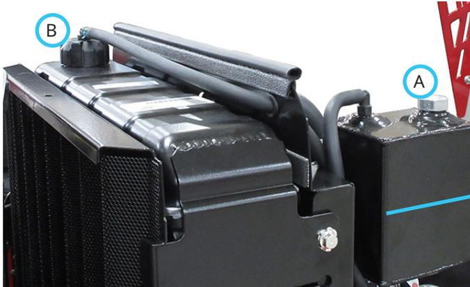
4. Si el nivel de refrigerante es bajo, añada refrigerante al depósito y vuelva a colocar el tapón.
