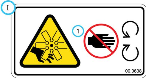
1. Seccionamiento de dedos o manos - ventilador del motor. Manténgase alejado de las piezas en movimiento.
