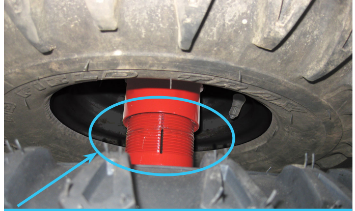
외부 겹바퀴를 조인 후 외부 겹바퀴 익스텐션에는 4개 이하의 나사산이 보여야 합니다.
