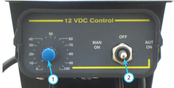
Der Motor wird mit Strom versorgt, indem der Schalter entweder auf „MAN ON“ oder „AUT ON“ gestellt wird. Wird der Schalter in die „MAN ON“ Stellung geschaltet, wird der Drehzahlregler ignoriert und der Motor läuft mit voller Leistung. Wird der Schalter in die „AUT ON“ Stellung geschaltet, kann die Motordrehzahl durch die Einstellung des Drehzahlreglers gesteuert werden.
