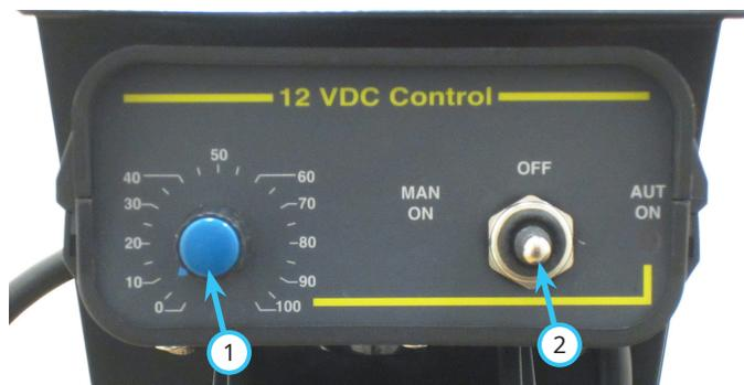
Il motore viene alimentato spostando l'interruttore in posizione MAN ON o AUT ON. Spostando l'interruttore in posizione MAN ON, viene ignorata la manopola di controllo della velocità e data piena potenza al motore. Spostando l'interruttore in posizione AUT ON, viene consentito il controllo del motore mediante le impostazioni della manopola di controllo della velocità.
