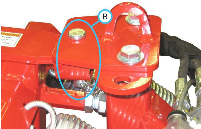
무거운 도장 작업을 진행할 때 루아웃 구멍(B)에 핀을 설치하여 블레이드 트립 메커니즘을 잠글 수 있습니다. 이 위치는 매우 느린 속도로 바닥을 파거나 긁을 때에만 사용해야 합니다.
