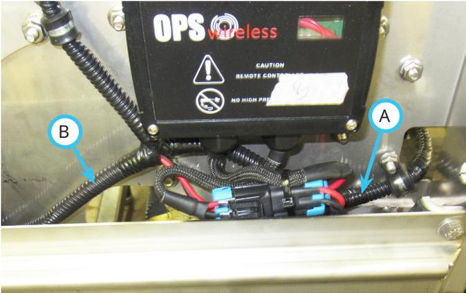
4. Scollegare il cablaggio di alimentazione (A) dal connettore dell'unità controller e collegare tra loro il connettore del cablaggio del motore e il connettore del cablaggio di alimentazione.
