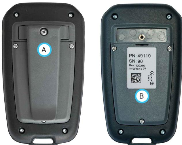
2. Rimuovere le tre viti che fissano il coperchio del vano batterie (B) al telecomando.
