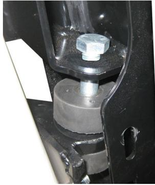
67. キャブのフロントサポートがキャブの取り付け穴と揃うまで、キャブを上げ下げする(キャブサポートは、キャブフレームの取り付けタブの内側に取り付けられます)。1/4 x 1"のステップボルト (49) 4本を取り付け、1/4"のフランジナットで固定する。締め付けないこと。
