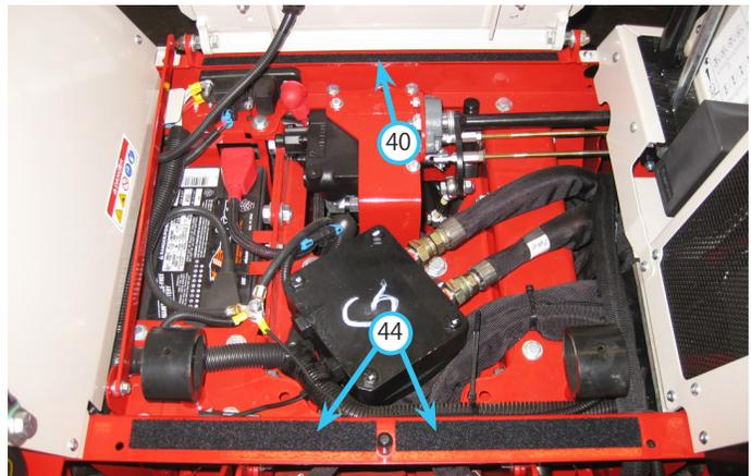
37. シートボックスフレームの後ろ側にある上部フランジに、長さ8"の1"ベルクロロール (44) を2つ取り付ける。
