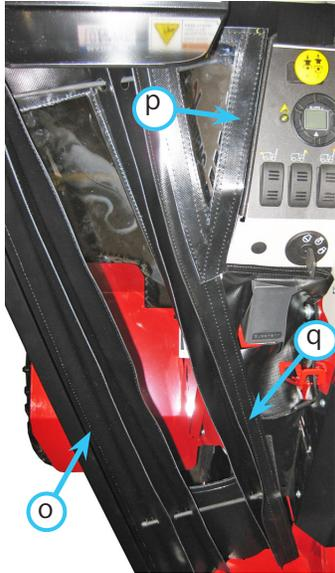
83. [4500] シートボックスフレームの背面から左側のブランクカバーを取り外し、切り欠きを通してワイヤーハーネスを配線し、先に取り付けたワイヤーハーネスに接続する。
