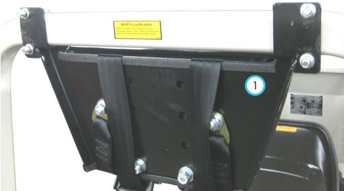
シートベルト上部マウントをロールバーの上部中央に配置し、3/8"ロックフランジナット4個で固定する。
