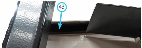
54. 左右のリアキャブマウントを識別する。キャブの取り付け面は前方に向かって傾斜し、ロールバーマウントの上部の穴も前方を向くことになる。
