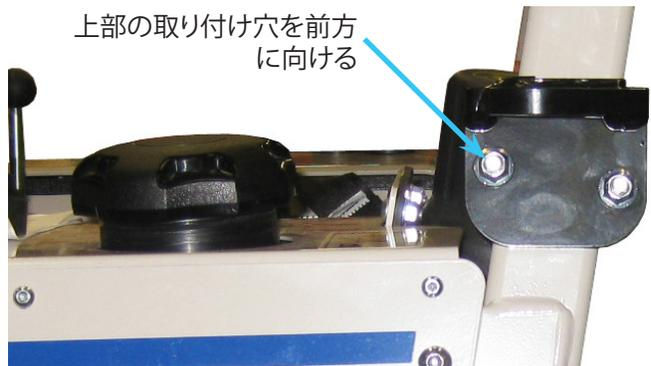
55. Uボルト2本と3/8"ロックフランジナット4個を使って、リアキャブマウントをロールバーに取り付ける。取り付けフランジの底面は、シートボックスパネルの上面と平行(T)で、ロールバーの底から約34 cm上にある必要があります。注意: リアブラケットと右下ウィンドウのガラスの穴、および下部ドアウィンドウがフレームマウントタブまたは下部サポートの穴と一致していない場合は、この距離を若干上下に調整する必要があります。
