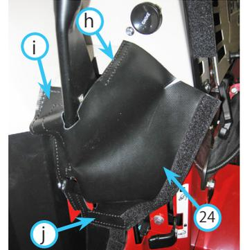
79. 三角形のウィンドウのベルクロが下を向くようにキャンバスのベローズを配置する。図のように左 (9) と右 (8) のベローズを識別する。
