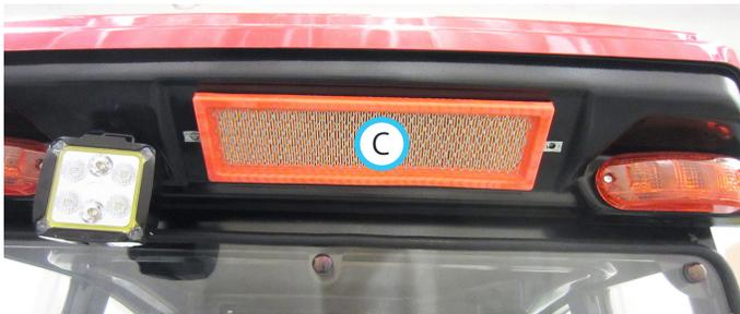
3. フィルターカバーを再度取り付け、つまみネジで固定する。
