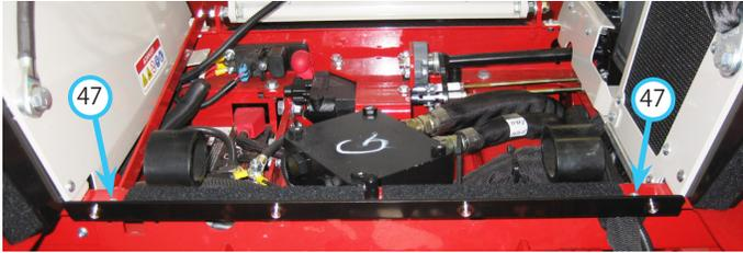
40. シートピンとボルトを使って、下部リアウインドウマウントの中央の穴に締め付ける。
