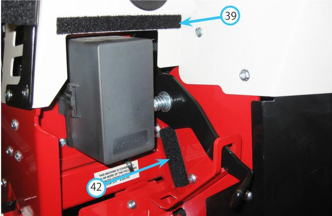
25. フロントフレームのハイ/ローシフトレバーとハイ/ローシフトロックブラケットの間に、長さ2-1/2"の1"ベルクロテープ (42) を取り付ける。
