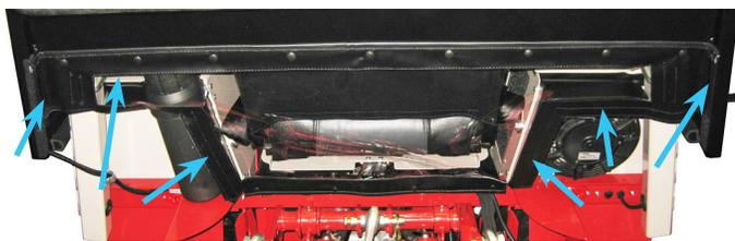
93. ウィンドウのヒンジピボットをキャブフレームのヒンジピンに差し込み、右フロントウィンドウと左右リアサイドウィンドウを取り付ける。ラッチをラッチピンの上に置き、押し下げてウィンドウを嵌め込む。
