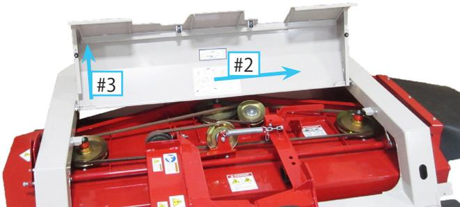
3. カバーの左側を持ち上げて左側にスライドさせ、右側のピンをキャリア フレームから取り外す。
