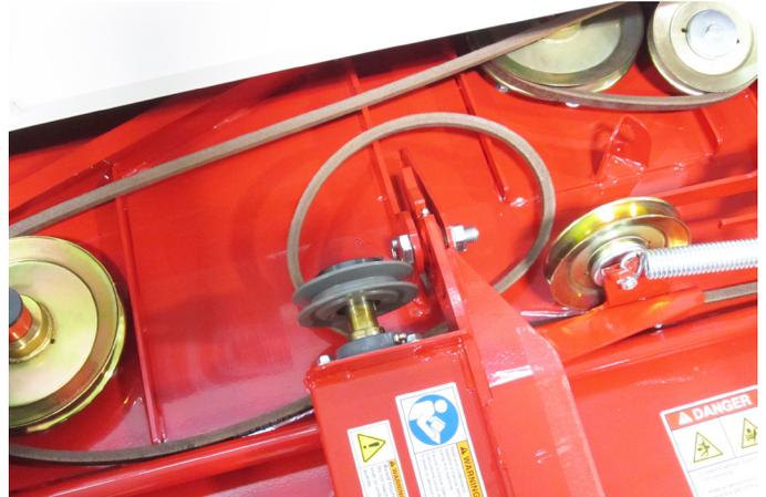
5. 左側ヒッチアーム取り付けボルトを外し、ヒッチアームを持ち上げて取り付けブラケットから外す。
