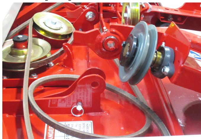
6. Ziehen Sie den Mähwerksriemen durch die Öffnung zwischen den Lenkern der Anbauvorrichtung und den Halterungen heraus.
