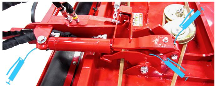
6. Bascule la carcasa de corte hacia arriba a la posición de mantenimiento. Engrase el cojinete izquierdo del rodillo trasero.
