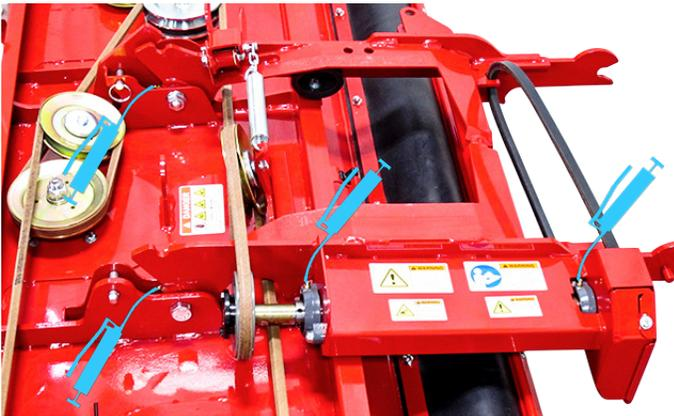
3. Engrase los ejes de las ruedas izquierda y derecha, los pivotes de las ruedas giratorias y los pivotes de los balancines traseros del bastidor de tiro.
