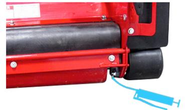
5. Si la carcasa de corte está equipada con un kit de basculación hidráulica, engrase los extremos de los cilindros y el soporte de basculación.
