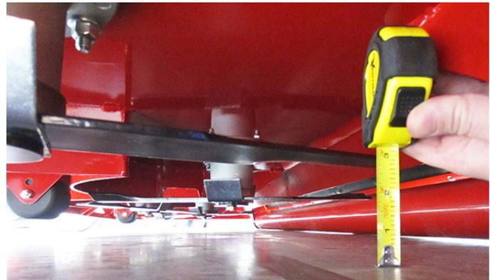
7. Gire la cuchilla para colocar la misma punta en la parte delantera de la carcasa y mida de nuevo. La punta de la cuchilla debe estar a la misma altura o hasta 3 mm más baja en la parte delantera. Si la distancia medida en la parte delantera es mayor que en la parte trasera, o si es menor en más de 3 mm que en la parte trasera, es necesario nivelar la carcasa.
