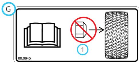
1. Placez ce côté-ci de la jante contre le moyeu de l'essieu. N'installez pas les écrous de roue de ce côté-ci de la jante. Consultez le manuel de l'utilisateur.
