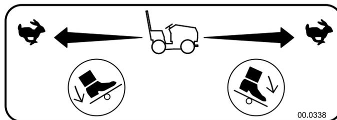
La pédale fonctionne conjointement avec le levier de commande SDLA. Elle peut servir à contrôler la vitesse et le sens de marche de l'unité motrice lorsque l'opérateur retire sa main du levier SDLA.
