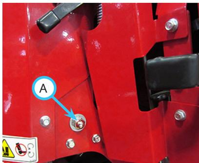
9. Desserrez légèrement l'écrou de réglage du point mort (A). REMARQUE : vous obtiendrez plus facilement le réglage souhaité en laissant l'écrou de réglage du point mort bien serré et en tapant sur l'écrou dans la direction souhaitée avec un maillet en caoutchouc ou un morceau de bois et un marteau. Ne frappez pas directement sur l'écrou avec un marteau métallique, vous risqueriez de le déformer ou de l'endommager.
