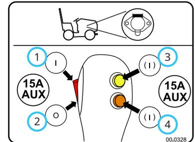
Appuyez sur le haut (1) de l'interrupteur à bascule pour mettre sous tension la prise 4 broches. Appuyez sur le bas (2) de l'interrupteur à bascule pour couper l'alimentation de la prise.
