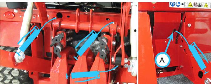
Le graisseur avant du vérin de l'attelage 3 points peut être graissé par un trou d'accès (A) dans le repose-pied droit.
