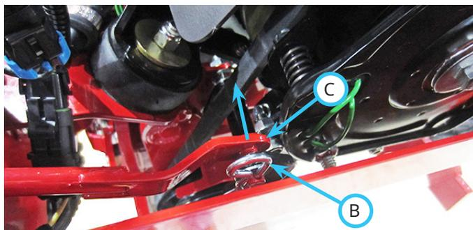
6. Retirez la tige de tension du mécanisme à bascule.
