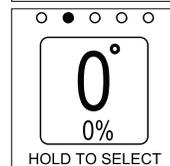
**Écran d'affichage 3 :** angle de pente global en degrés, avec un horizon visuel et un indicateur de roulis.
