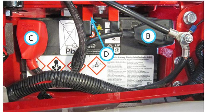
5. Retirez le dispositif de retenue de la batterie (D).
