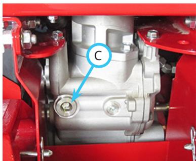
REMARQUE : sur certaines unités motrices, il peut être nécessaire de déposer la plaque de protection de la boîte-pont arrière pour accéder au bouchon de vidange.
