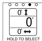
**Écran d'affichage 5 :** angle de pente global en degrés, angle longitudinal et angle latéral et indicateurs de position.
