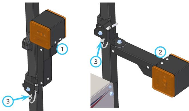
Pour changer la position des clignotants, retirez la goupille de verrouillage (3), amenez le bras à la position souhaitée et réinsérez la goupille de verrouillage.
