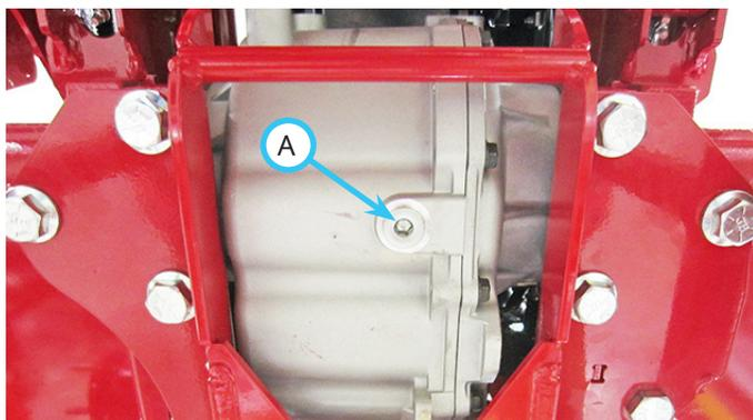
7. Remettez le bouchon en place sur la boîte-pont avant et serrez-le à un couple de 34 à 39 N·m.
