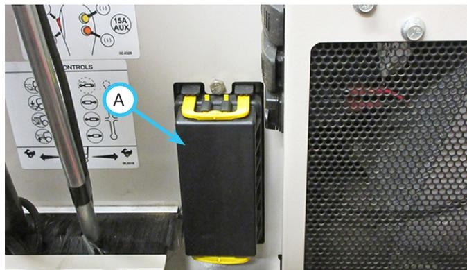
4. Identifiez et retirez le fusible défectueux de son logement. Voir l'emplacement des fusibles indiqué sur l'autocollant de référence rapide sous le capot.
