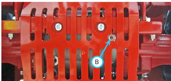
3. Retirez le bouchon de vidange (B) de la boîte-pont arrière et laissez l'huile hydraulique s'écouler. Retirez le bouchon de remplissage d'huile (C) de la boîte-pont arrière pour créer un appel d'air.
