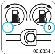
Pour éviter toute fuite de carburant lors du remplacement des filtres à carburant ou de l'entretien du circuit de carburant, tournez le robinet dans le sens des aiguilles d'une montre (0) jusqu'en butée de manière à couper l'écoulement du carburant.
