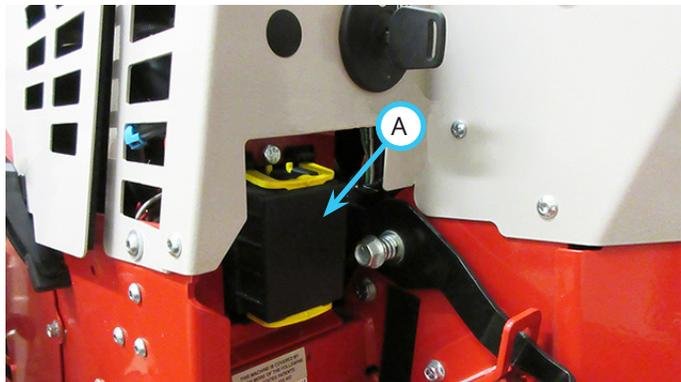
3. Identifiez et retirez le fusible défectueux de son logement. Voir l'emplacement des fusibles indiqué sur l'autocollant de référence rapide sous le capot.
