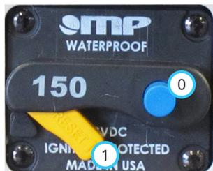
Lorsque le bouton est enfoncé sur le commutateur pour désactiver l'alimentation électrique, un levier de réarmement (1) s'abaisse sous le corps du commutateur.
