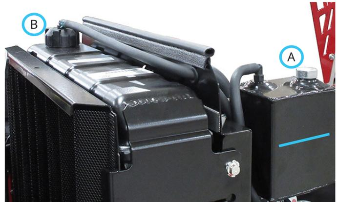
4. Si le niveau de liquide de refroidissement est trop bas, ajoutez du liquide de refroidissement dans le vase d'expansion et remettez le bouchon en place.
