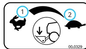
L'attelage avant et l'outil peuvent être immobilisés dans n'importe quelle position, afin qu'ils ne s'abaissent pas, en tournant le bouton de la vanne d'attelage avant dans le sens des aiguilles d'une montre jusqu'à ce que la vanne soit complètement fermée. Lorsque vous utilisez un outil sur l'attelage 3 points, il peut être utile de verrouiller l'attelage avant et son outil en position relevée, afin d'éviter un abaissement accidentel de l'outil avant.
