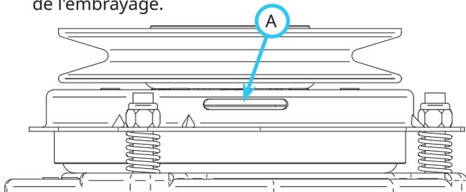
2. Insérez une jauge d'épaisseur de 0,5 mm par la fenêtre d'inspection et dans la fente entre l'armature et le rotor.
