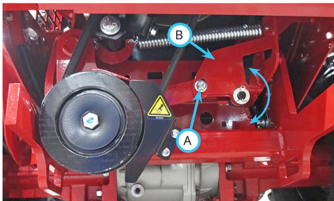
3. Serrez solidement le boulon de réglage. Serrez à 42 N·m.
