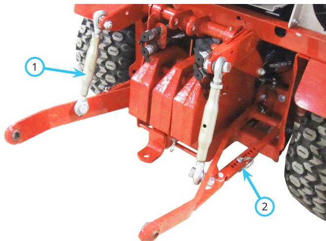
L'attelage 3 points optionnel est doté de bielles de relevage réglables (1) permettant de contrôler individuellement les barres de traction. Les stabilisateurs (2) peuvent coulisser librement ou être verrouillés dans la position souhaitée.
