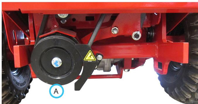
Une fois la courroie de la prise de force en place sur la poulie d'entraînement, poussez la tige de tension de la courroie pour engager et tendre la courroie.
