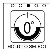
**Écran d'affichage 4 :** angle de pente global en degrés, angle longitudinal et angle latéral.
