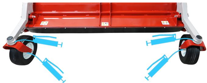
Fetten Sie die Rotorlager und die Drehgelenke des Querrahmens auf beiden Seiten des Mähwerks.
