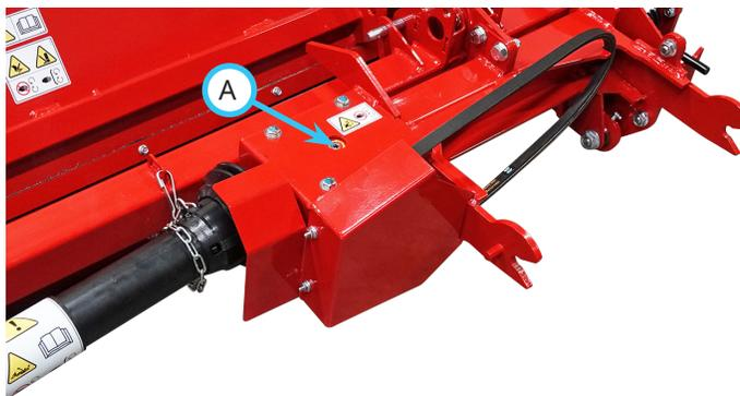
3. Prüfen Sie den Ölstand im Getriebe. Der Ölfüllstand sollte bei etwa halbem Füllstand gehalten werden. Ist der Ölfüllstand zu niedrig, füllen Sie synthetisches Getriebeöl vom Typ 75W-140 nach, bis der richtige Ölfüllstand erreicht ist.
