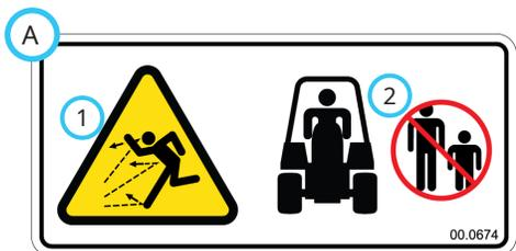
1. Gefahr durch herausgeschleuderte Objekte.
