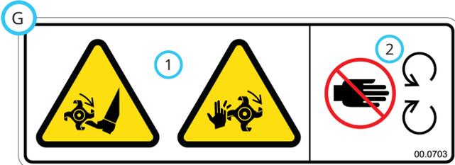
1. Gefahr von Schnittverletzungen oder Amputation von Händen oder Füßen durch rotierende Hackmesser.
