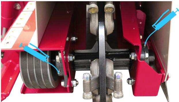
3. Fetten Sie die Zylinderenden und die Drehpunkte am Messer-/Ständerrahmen ein.
