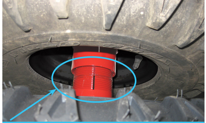
외부 겹바퀴를 조인 후 외부 겹바퀴 익스텐션에는 4개 이하의 나사산이 보아야 합니다.
